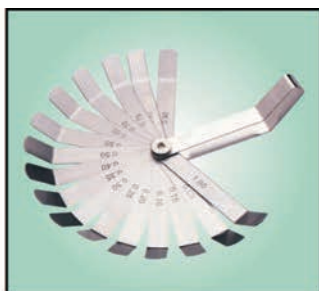
Szczelinomierze najczęściej Wykorzystywane w trudno dostępnych miejscach
